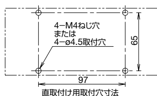
直取付け用取付穴寸法
