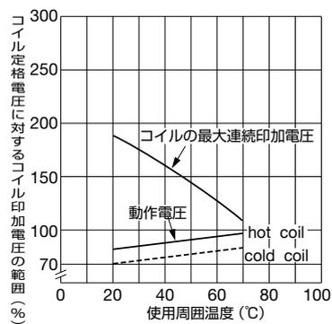
(注) hot coil: コイル..... 定格電圧印加
